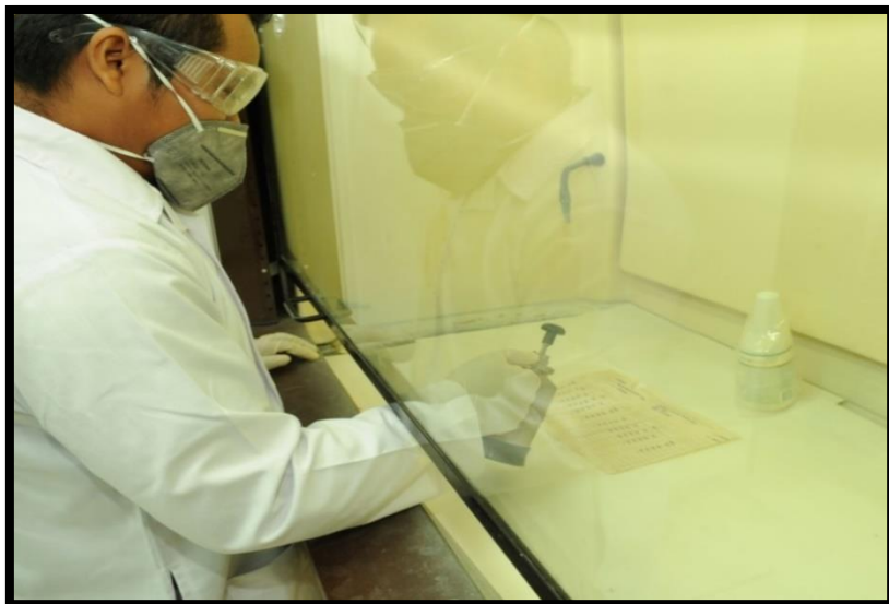
Gambar 12: Proses Pengenyahan Asid Bukan Akuas (Kering)
