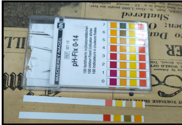
Gambar 10: Ujian pH secara manual (kertas penunjuk pH Universal)
